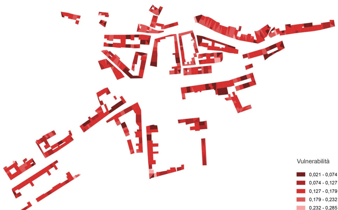
Figura 8 – Vulnerabilità del tessuto urbano analizzato. Sono campiti gli edifici prospettanti sulle strade, interessati da interventi sulle rispettive unità di facciata.
